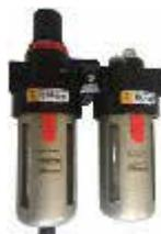
É melhor instalar um regulador de pressão de filtro duplo na entrada de ar de cada bomba de diafragma (o primeiro copo com drenagem, o segundo copo com óleo branco /óleo anticongelante). Além disso, descarregue regularmente a água no compressor e no tubo de transporte de ar para garantir a entrada de ar limpo e seco.
