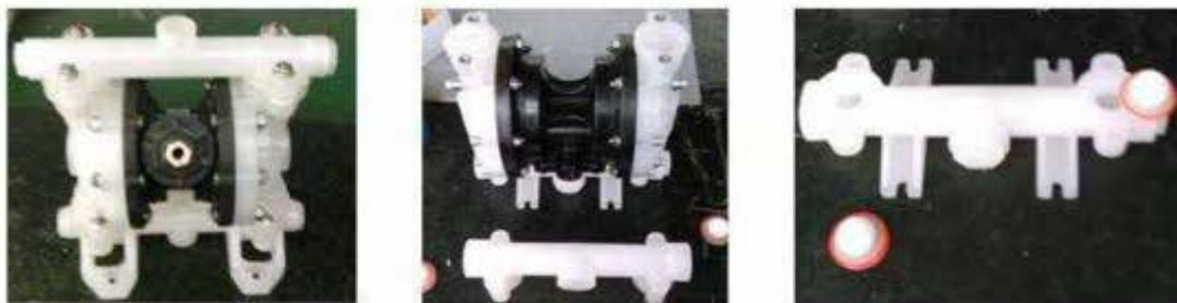
Além disso, coloque a esfera no assento da válvula, caso haja um grande espaço entre a esfera e o assento da válvula, isso indica que há uma intensa abrasão da esfera, o que pode ocasionar em uma vedação inadequada e refluxo líquido, sendo assim, a bomba não funcionará eficientemente e o fluido não será transferido facilmente. Nessa condição, a esfera deve ser substituída. É a forma de resolver a operação da bomba sem líquido.
