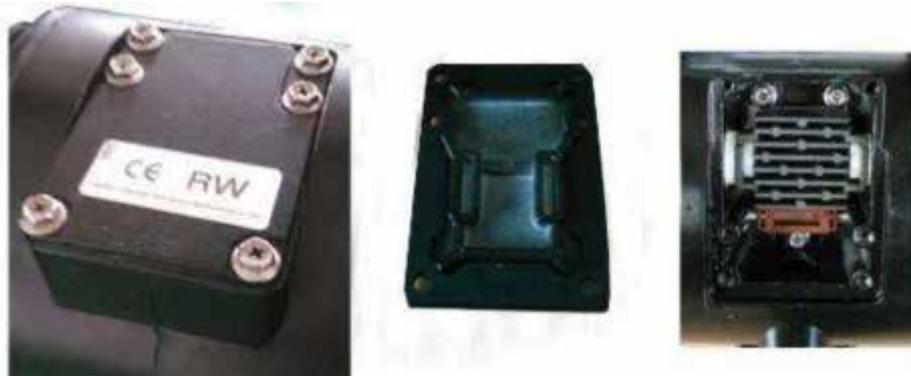
2. Verifique se o transmissor de comutação apresenta vazamento de ar, verifique se a conexão do transmissor de comutação e do pino de comutação está rompida.
