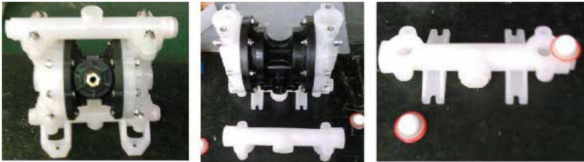
Além disso, coloque a esfera no assento da válvula, caso haja um grande espaço entre a esfera e o assento da válvula, isso indica que há uma intensa abrasão da esfera, o que pode ocasionar em uma vedação inadequada e refluxo líquido, sendo assim, a bomba não funcionará eficientemente e o fluido não será transferido facilmente. Nessa condição, a esfera deve ser substituída. É a forma de resolver a operação da bomba sem líquido.
